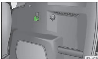
Fig. 55 Coffre à bagages : Crochet rabattable
