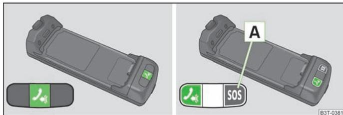
Fig. 111 Schéma du principe : Adaptateur à une touche/adaptateur à deux touches
