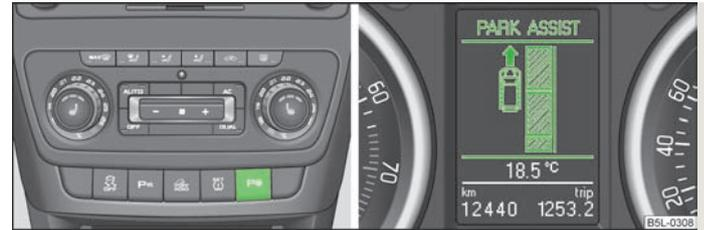
Fig. 101 Enclencher l'affichage de l'assistant aux manœuvres de stationnement sur le visuel d'informations/visuel d'informations : Recherche d'une place de stationnement appropriée
