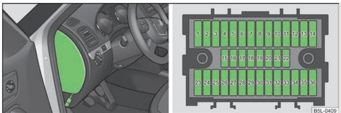
Fig. 167 Couvercle de la boîte à fusibles sur le dans le tableau de bord/re-présentation schématique de la boîte à fusibles
