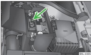
Fig. 149 Batterie du véhicule : indicateur de niveau de l'électrolyte
