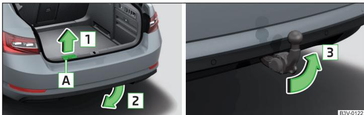
Fig. 220 Boule d'attelage : retirer/insérer
