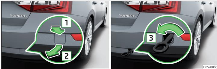
Fig. 253 Démontage du cache/montage de l'œillet de remorquage
