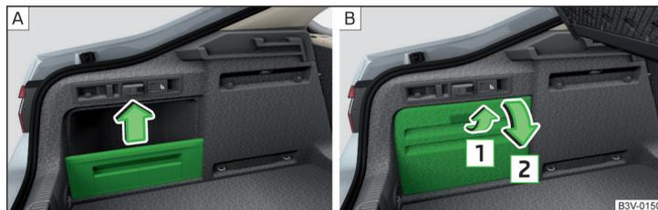
Fig. 138 Retirer/ouvrir les compartiments latéraux
