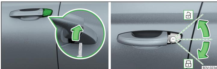
Fig. 259 Poignée dans la portière conducteur : Rotations de la clé pour déverrouiller et verrouiller
