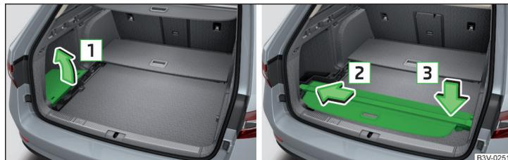
Fig. 135 Retirer le couvre-bagages à gauche / ranger le couvre-bagages enroulable
