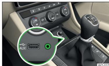
Fig. 111 Emplacement de montage des entrées AUX
