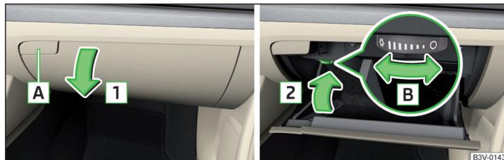
Fig. 101 Ouvrir le vide-poches / fermer le vide-poches et ouvrir la ventilation
