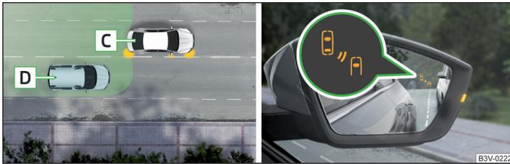
Fig. 216 La situation de conduite / le voyant dans le rétroviseur extérieur de droite indique la situation de conduite
