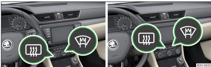
Fig. 65 Touches pour le chauffage du pare-brise et de la lunette arrière : Climatronic / Système de climatisation manuel
