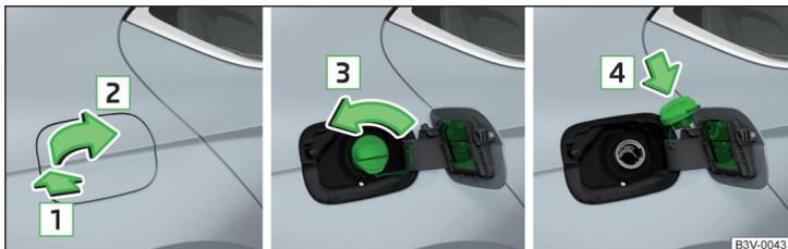
Fig. 224 Ouvrir la trappe du réservoir / Dévisser le bouchon du réservoir / Placer le bouchon du réservoir sur la trappe du réservoir
