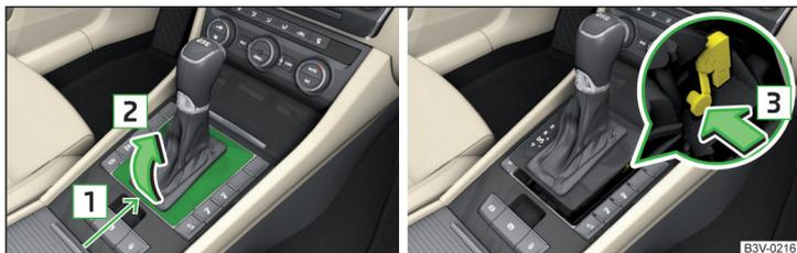
Fig. 263 Déverrouillage de secours du levier sélecteur
