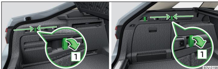
Fig. 129 Rabattre les crochets vers le bas : variante 1 / variante 2
