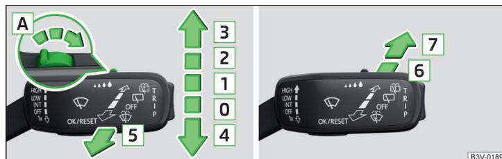
Fig. 69 Commande des essuie-glaces et du lave-glace : avant/arrière
