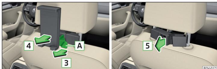
Fig. 123 Démontez le support / retirez l'adaptateur
