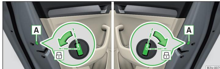
Fig. 261 Verrouillage de secours : portière arrière gauche/droite
