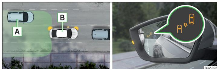
Fig. 215 La situation de conduite / le voyant dans le rétroviseur extérieur de gauche indique la situation de conduite
