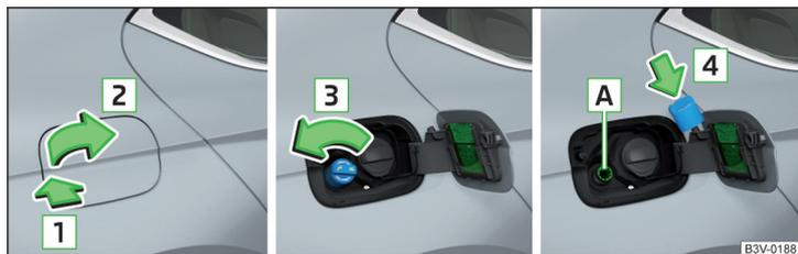
Fig. 226 Ouvrir la trappe du réservoir / Dévisser le bouchon du réservoir / Placer le bouchon du réservoir sur la trappe du réservoir
