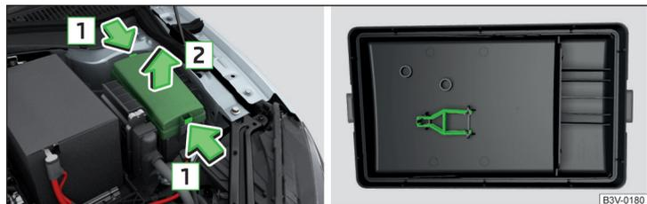
Fig. 269 Cache de la boîte à fusibles : retirer le cache / agrafe en plastique pour les fusibles
