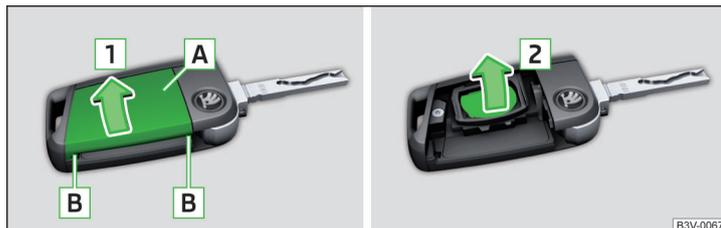
Fig. 254 Clé à radiocommande : Démontez le cache / retirez la pile
