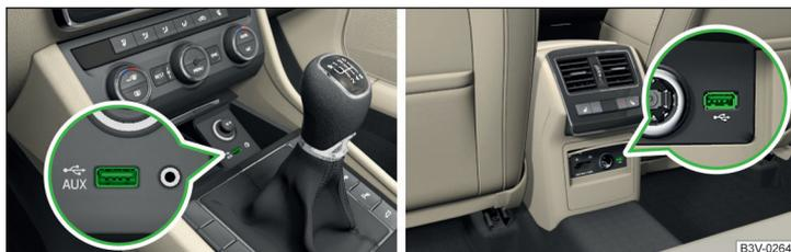
Fig. 110 Emplacements de montage des entrées USB dans la console centrale à l'avant/à l'arrière
