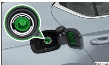
Fig. 225 Tubulure de remplissage de carburant sur les véhicules équipés d'un moteur diesel
