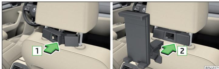
Fig. 122 Fixez l'adaptateur / montez le support
