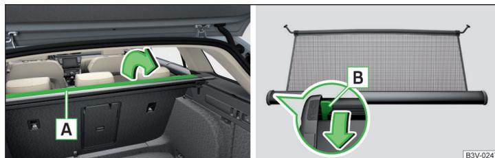
Fig. 149 rabattre une partie du couvre-bagages enroulable / levier de déverrouillage
