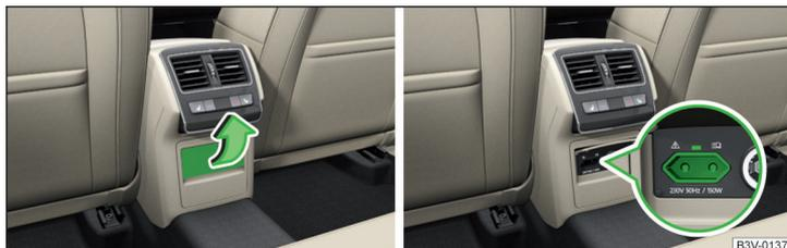
Fig. 116 Rabattre le couvercle de la prise 230 Volts / prise 230 Volts
