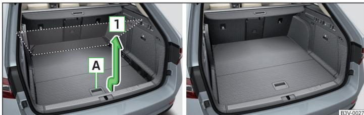
Fig. 145 Régler le plancher de chargement variable en position supérieure / Plancher de chargement variable en position supérieure
