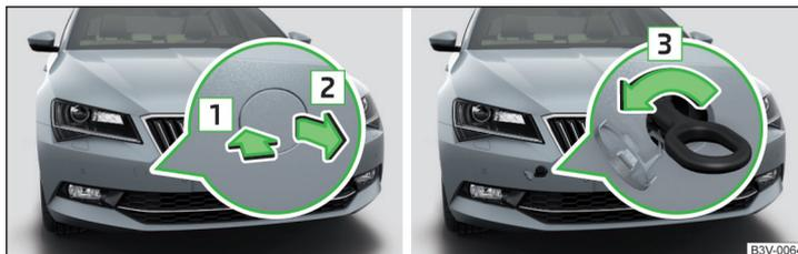
Fig. 252 Démontage du cache/montage de l'œillet de remorquage
