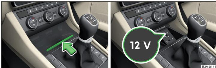
Fig. 112 Ouvrir le compartiment de rangement / le cache de la prise 12 Volts
