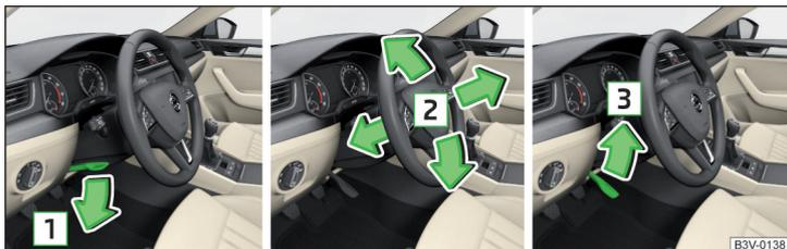
Fig. 3 Réglage de la position du volant
