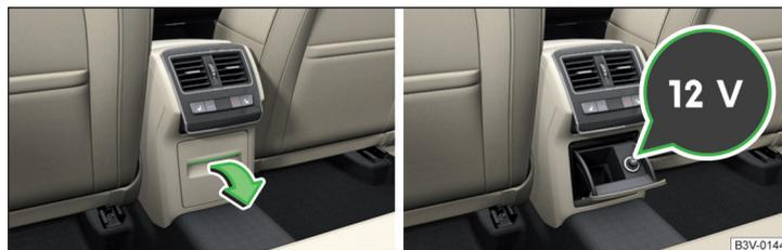
Fig. 114 Ouvrir le compartiment de rangement / le cache de la prise 12 Volts
