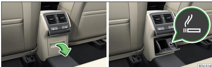
Fig. 118 Console centrale arrière : Ouverture du vide-poches/allume-cigares
