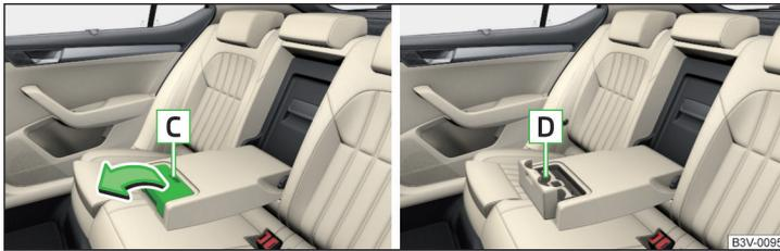
Fig. 95 Accoudoir arrière : Ouvrir le porte-gobelet / Porte-gobelet
