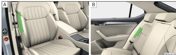
Fig. 11 Emplacement de montage de l'airbag : dans le siège avant / à l'arrière
