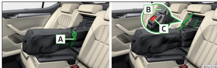
Fig. 109 Enfiler la sangle / fixer le sac de chargement
