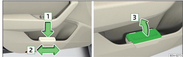
Fig. 96 Poubelle : insérer et déplacer / ouvrir
