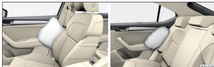
Fig. 12 Airbags remplis de gaz
