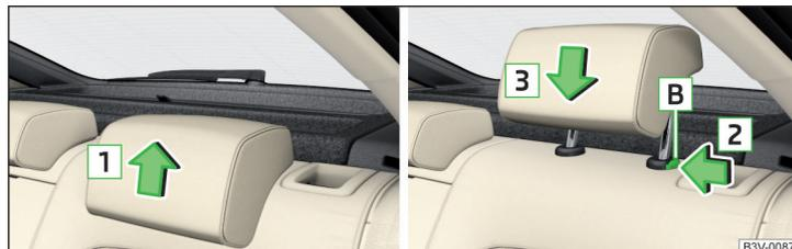
Fig. 83 Appuie-tête arrière : tirer vers le haut / pousser vers le bas
