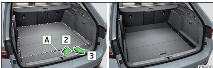
Fig. 146 Régler le plancher de chargement variable en position inférieure / Plancher de chargement variable en position inférieure
