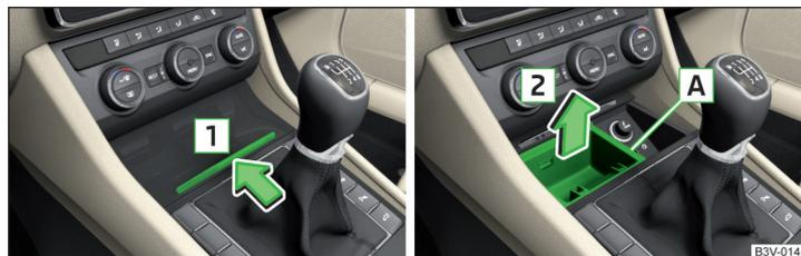
Fig. 119 Console centrale avant : Ouvrir le compartiment de rangement / le cendrier
