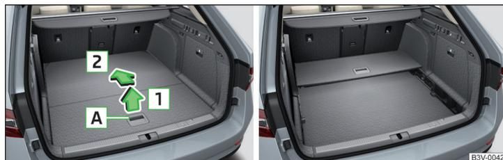
Fig. 147 Replier le plancher de chargement variable / plancher de chargement variable replié dans la position supérieure
