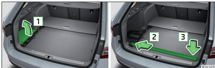
Fig. 137 Retirer le cache latéral à gauche / ranger la poche multifonction
