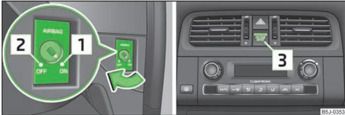
Fig. 103 Commutateur à clé pour l'airbag frontal du passager avant/témoin de désactivation de l'airbag frontal du passager avant
