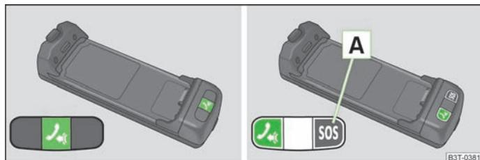
Fig. 88 Schéma du principe : Adaptateur à une touche/adaptateur à deux touches
