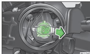
Fig. 144 Démontage de l'ampoule du feu de croisement et de route
