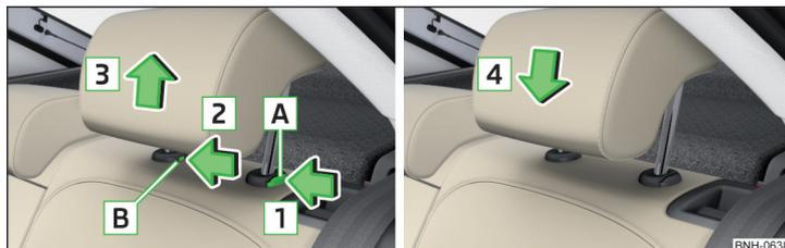
Fig. 59 Retirer/Insérer les appuie-têtes arrière
