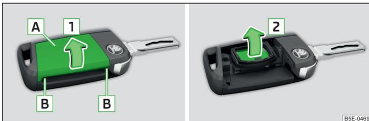
Fig. 170 Démontez le cache / retirez la pile
