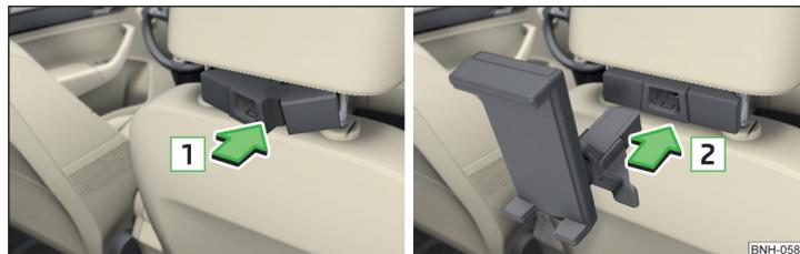
Fig. 81 Insertion : Adaptateur / Support
