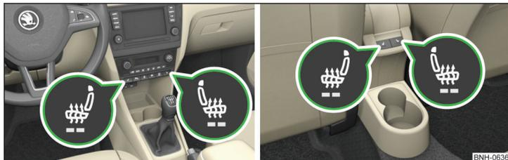
Fig. 60 Touches du chauffage des sièges avant/des sièges arrière
