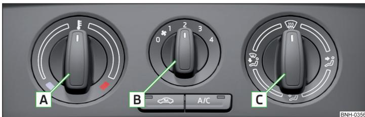
Fig. 95 Éléments de commande du chauffage/climatiseur
