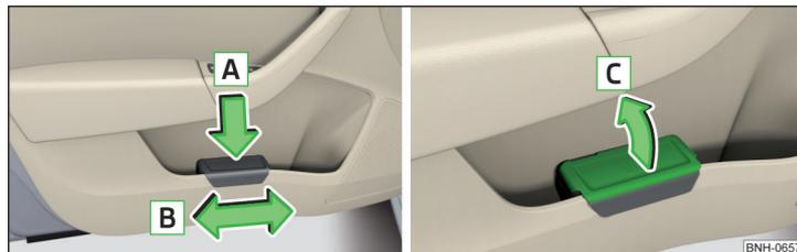
Fig. 68 Poubelle : insérer et déplacer / ouvrir
