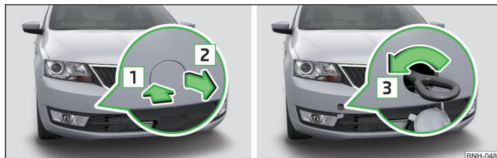
Fig. 168 Retirer le cache / monter l'œillet de remorquage
