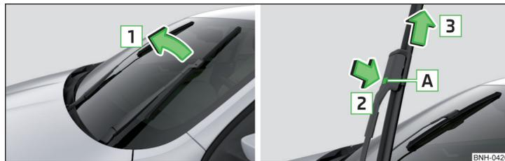
Fig. 176 Remplacer les balais d'essuie-glace du pare-brise avant
