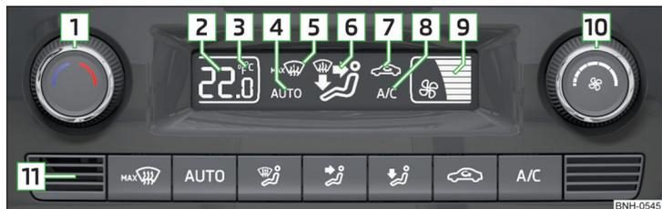
Fig. 96 Éléments de commande du climatiseur
