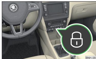
Fig. 32 Touche de verrouillage centralisé
