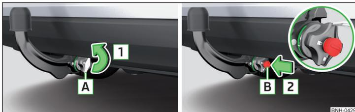
Fig. 136 Retirez le cache de la serrure / Insérez la clé dans la serrure
