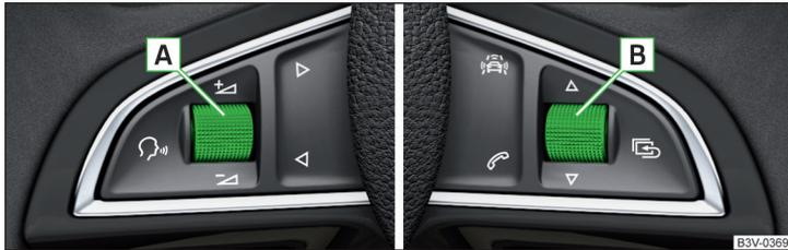
Fig. 25 Boutons/Roues de réglage sur le volant multifonctions
