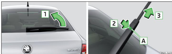
Fig. 177 Remplacez le balai d'essuie-glace de la lunette arrière.
