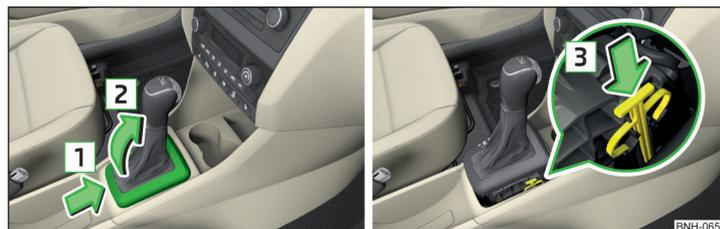
Fig. 174 Retirer le cache / déverrouiller le levier sélecteur
