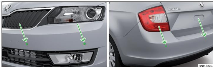
Fig. 110 Emplacement de montage des capteurs du côté gauche du véhicule : avant/arrière
