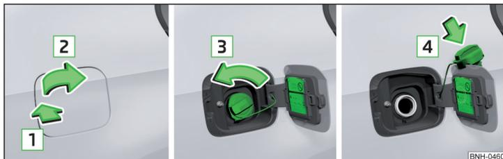
Fig. 144 Ouvrir la trappe du réservoir/Dévisser le bouchon du réservoir/Visser le bouchon du réservoir dans la trappe
