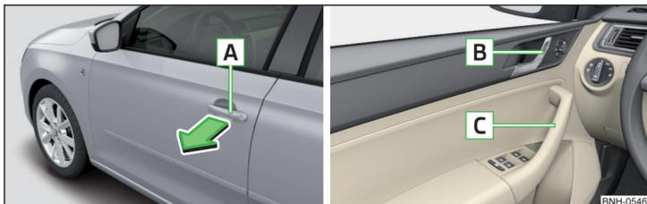
Fig. 33 Poignée de la porte / manette d'ouverture des portes
