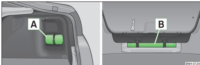
Fig. 110 Emplacement du triangle de pré-signalisation
