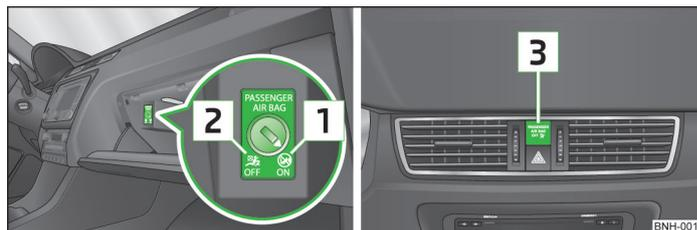
Fig. 86 Commutateur à clé pour l'airbag frontal du passager avant/témoin de désactivation de l'airbag frontal du passager avant
