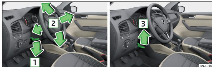
Fig. 2 Réglage de la position du volant
