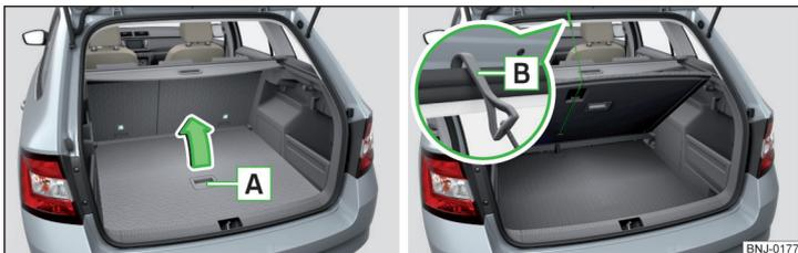
Fig. 94 Soulever le plancher de chargement variable / fixer le plancher de chargement variable
