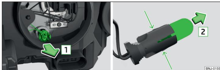
Fig. 187 Remplacement de l'ampoule du feu de position
