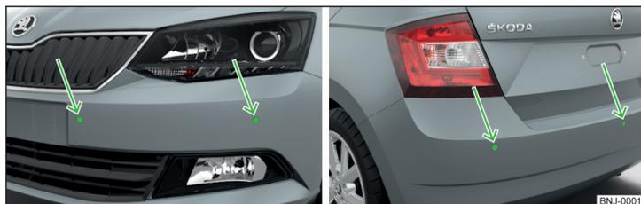
Fig. 115 Lieu d'installation des capteurs à ultrasons : avant/arrière
