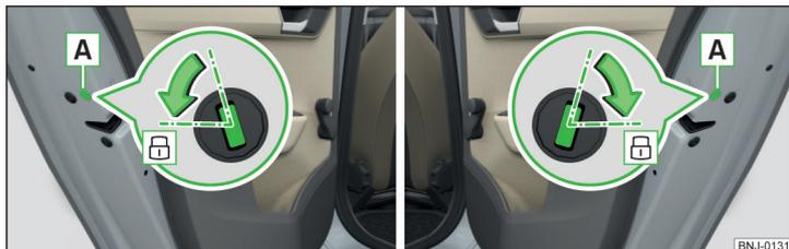
Fig. 173 Verrouillage de secours : portière arrière gauche/droite
