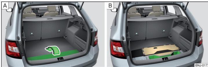
Fig. 89 Rabattre le plancher / compartiment de rangement sous le plancher
