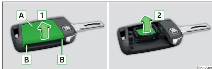
Fig. 171 Démontez le cache / retirez la pile
