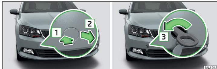
Fig. 169 Démontage du cache/montage de l'œillet de remorquage
