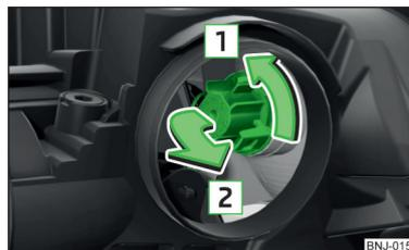
Fig. 186 Remplacement de l'ampoule du clignotant avant
