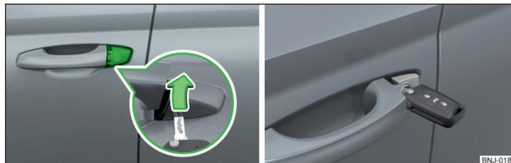
Fig. 172 Poignée dans la portière conducteur : Barillet de serrure recouvert/barillet de serrure avec clé
