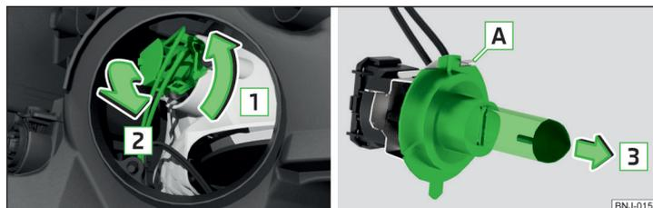
Fig. 189 Remplacement de l'ampoule du feu de croisement
