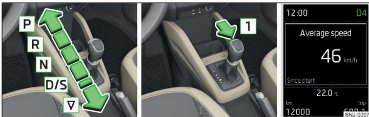
Fig. 110 Levier sélecteur / touche de verrouillage / affichage sur le visuel
