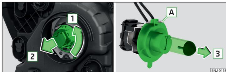
Fig. 190 Remplacement de l'ampoule des feux de route
