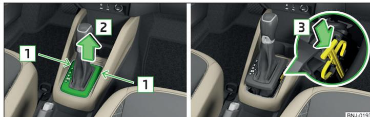
Fig. 175 Déverrouillage de secours du levier sélecteur
