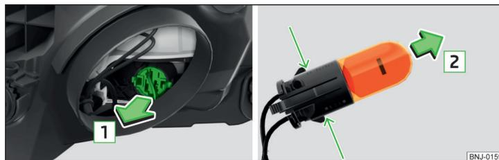
Fig. 191 Remplacement de l'ampoule du clignotant
