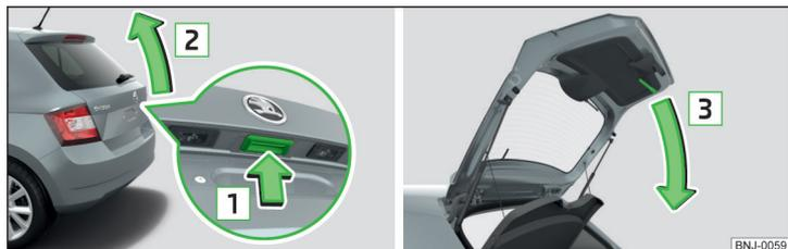
Fig. 37 Ouverture/fermeture du capot du coffre à bagages
