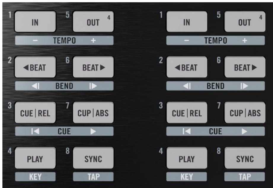
Le groupe de boutons en bas du TRAKTOR KONTROL X1 est dédié aux contrôles de transport de TRAKTOR. En plus de l'accès direct aux fonctions de TRAKTOR, ces boutons indiquent l'état de plusieurs de ces fonctions grâce à leur code de couleur lumineux.
