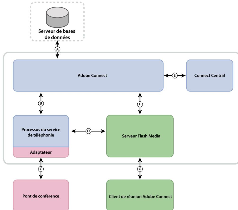
A. Connexion permanente. B. Gestion des services et défaillance, connexion de service et courtage de sessions, fourniture des données utilisateur et accès à ces données. C. Commandes natives et événements utilisant les API fournisseur propriétaires pour le contrôle de conférence. D. Commandes et événements utilisant les appels RPC. E. Fourniture. F. Demande de service de téléphonie. G. Commandes de téléphonie et état.
