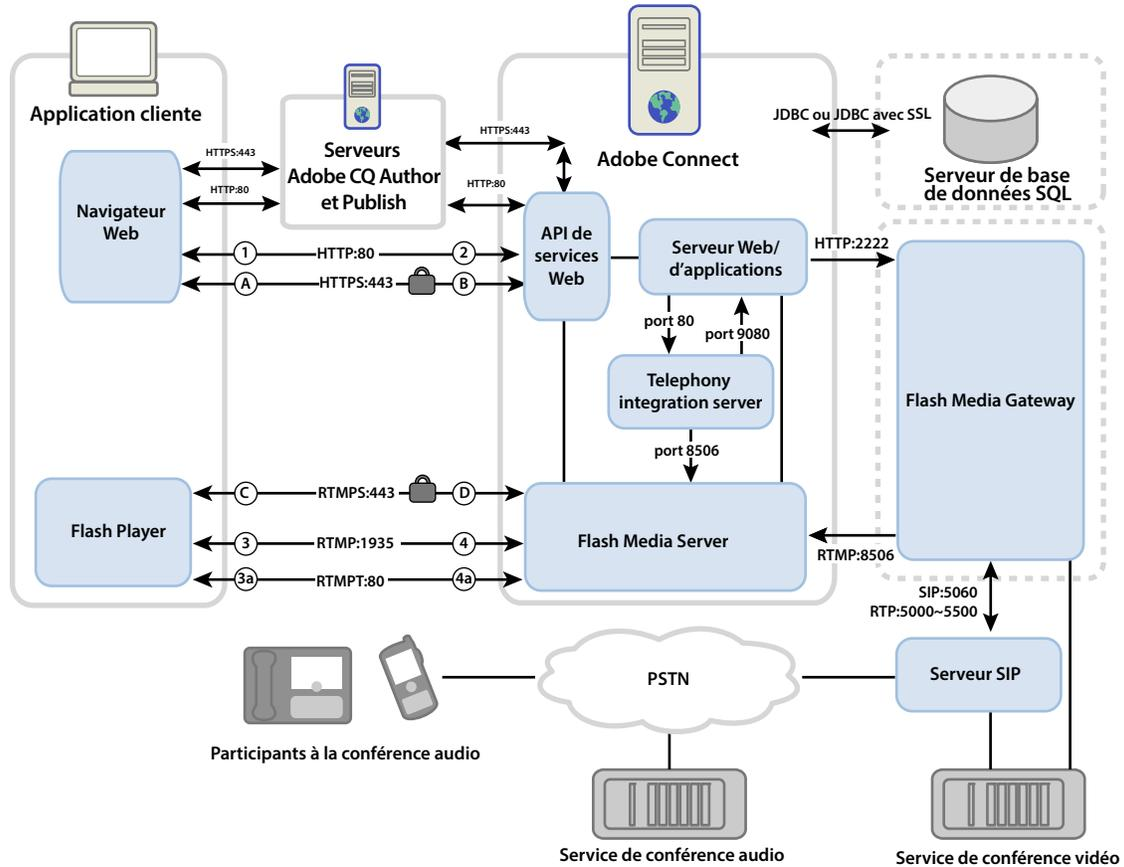
Les données peuvent circuler sur une connexion chiffrée ou non chiffrée.
