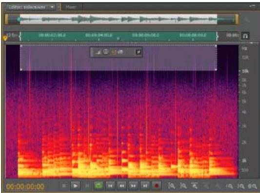
Affichage spectral avec sélection des hautes fréquences
