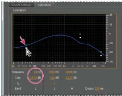
Le déplacement d'un point de contrôle modifie les paramètres correspondants et inversement.
