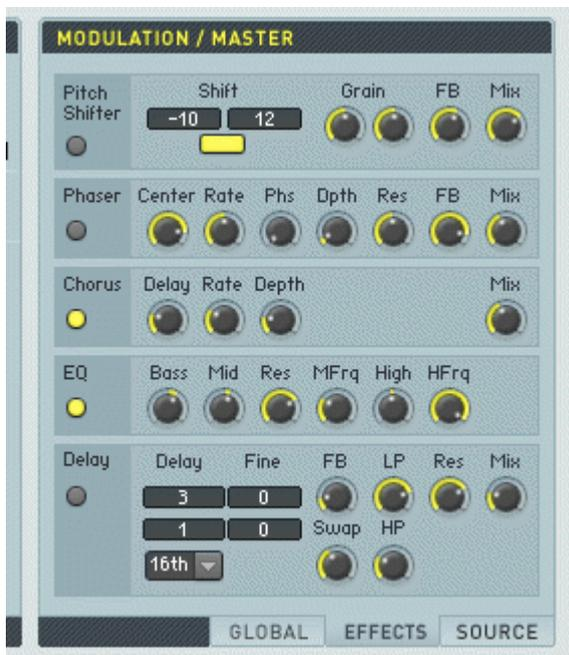
Fig. 3.4 L'onglet Effects avec les effets Chorus et EQ activés.
