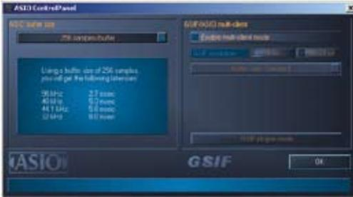
Par exemple, le panneau de contrôle ASIO des interfaces Terratec EWX vous permet de choisir un nombre défini d'échantillons dans le tampon. L'affichage indique alors la latence qui en résulte. Dans ce cas, l'option "256 échantillons/tampon" a été sélectionnée, ce qui donne une latence juste au-dessous de 6 ms à 44,1 kHz. Un réglage à 128 échantillons/tampon réduira la latence, mais peut donner plus de fil à retordre à votre ordinateur.
