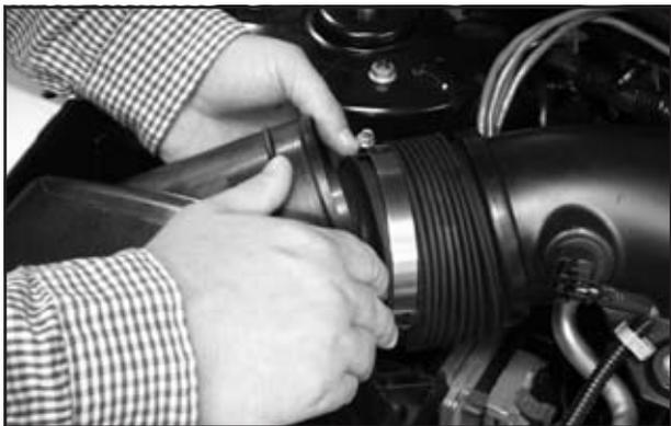
2. Débrancher le tuyau flexible.
