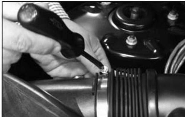
1. Dévisser le joint du tuyau flexible de la conduite d'air.
