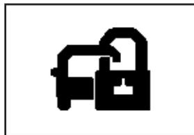
Votre véhicule est équipé d'un système antivol Passlock®. Ce système fait en sorte que le témoin de sécurité clignote lorsque vous ouvrez une porte si le contact est coupé.
