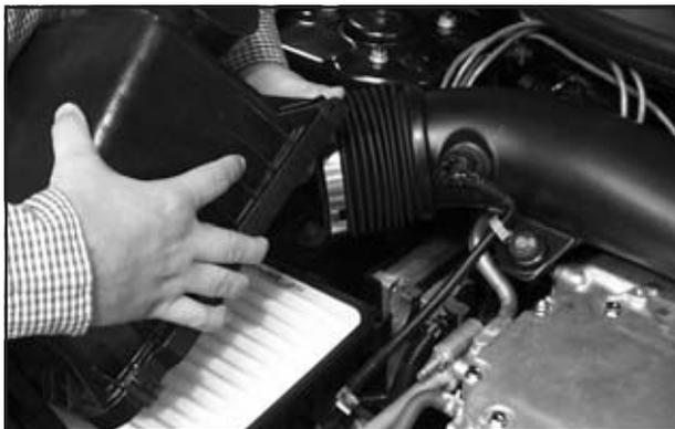
5. Retirer le couvercle et l'élément du filtre à air.
