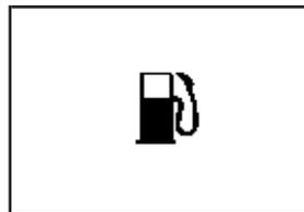
Le témoin à côté de l'indicateur de carburant s'allume brièvement lorsque vous faites démarrer le moteur.
