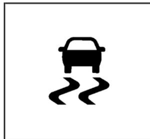
Pour mettre le système en ou hors fonction, presser et relâcher le bouton ESC/TCS se trouvant sur le tableau de bord.
