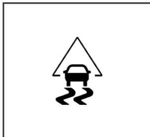
Quand ce témoin reste allumé et que le message SERVICE TRACTION (réparer le système de traction asservie) ou TRACTION OFF (traction asservie hors fonction) est affiché, le système ne limite pas le patinage des roues.
