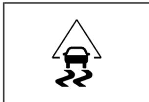
Le témoin du système de contrôle électronique de la stabilité (ESC) ou du système de traction asservie (TCS) s'allume brièvement au démarrage du moteur.
