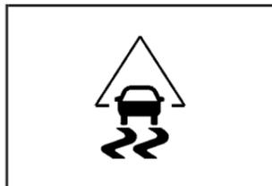
Ce témoin clignote au groupe d'instruments du tableau de bord si l'ESC est à la fois en fonction et activé.
