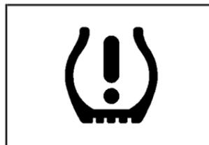
Sur les véhicules dotés d'un témoin de pression des pneus, ce témoin s'allume brièvement lorsque le moteur démarre.
