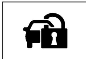
Le témoin de sécurité situé sur le groupe d'instruments du tableau de bord s'allume pour indiquer que le système est armé.
