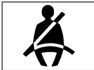
Le témoin de rappel de bouclage de ceinture de sécurité s'allume et reste allumé pendant quelques secondes, puis clignote pendant quelques secondes de plus.
