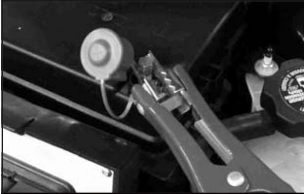
6. Enlever le couvercle de borne et brancher le câble positif (+) rouge à la borne positive (+) du véhicule dont la batterie est déchargée. Utiliser une borne (+) positive auxiliaire si le véhicule est ainsi équipé.
