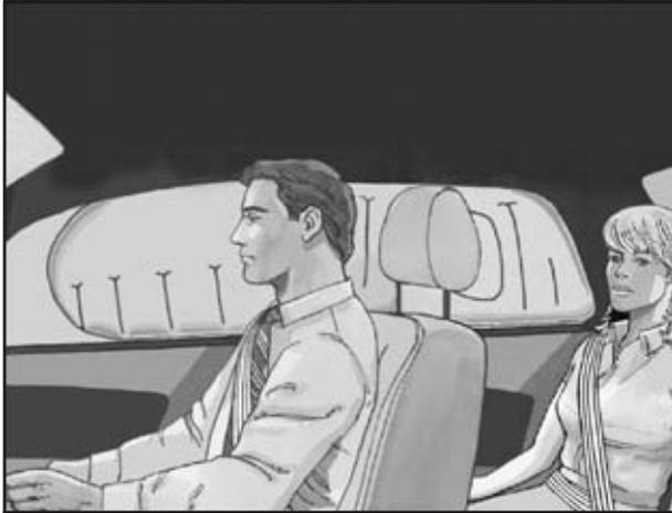
Sur les véhicules équipés d'un sac gonflable latéral pour le passager avant et le passager assis immédiatement derrière, le sac se trouve au plafond, au-dessus des glaces latérales.
