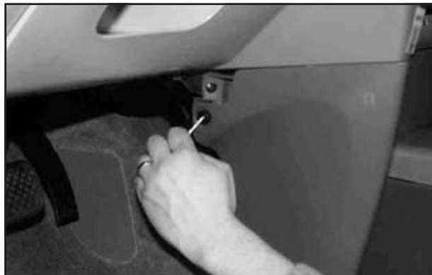
Certains fusibles se trouvent dans une boîte à fusibles du côté conducteur de la console de plancher. Pour retirer le couvercle de la console de plancher, reculer le siège du conducteur autant qu'il est possible, et tirer sur le couvercle de la console de plancher, à partir de l'avant du véhicule, en l'écartant de la console.
