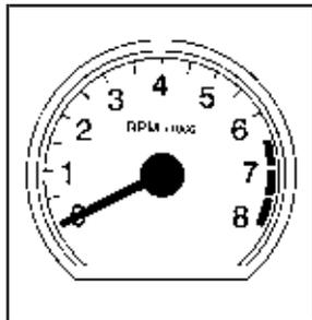
Le compte-tours est situé sur le tableau de bord et affiche la vitesse de rotation du moteur en tours par minute (tr/min).
