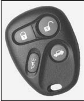
**🔒 (verrouillage) :** Appuyer sur ce symbole de l'émetteur de télédéverrouillage pour verrouiller les portes. Le système antivol sera également activé. Se reporter à la rubrique *Systèmes antivol* à la page 2-17.
