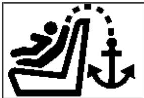
Pour vous aider à localiser les ancrages supérieurs d'attache, le symbole supérieur d'attache est placé sur le couvercle de garnissage.
