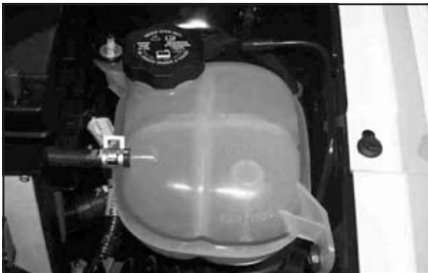
Le réservoir d'expansion se trouve dans le compartiment-moteur, côté passager. Voir *Aperçu du compartiment moteur* à la page 5-14 pour des précisions sur son emplacement.
