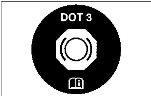
L'embrayage hydraulique et le maître-cylindre des freins utilisent le même réservoir. Le réservoir est rempli de liquide pour freins DOT-3. Se reporter à la rubrique *Aperçu du compartiment moteur à la page 5-14* pour connaître l'emplacement du réservoir.
