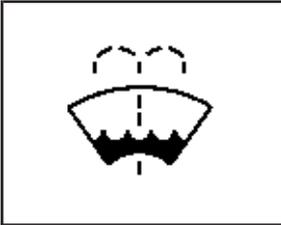
Enlever le bouchon marqué du symbole de lave-glace. Ajouter du liquide jusqu'à ce que le réservoir soit plein. Voir *Aperçu du compartiment moteur à la page 5-14* pour connaître l'emplacement du réservoir.
