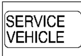
Si le message SERVICE VEHICLE (faire réparer le véhicule) s'affiche, un problème non lié au système antipollution s'est produit et il faut faire réparer le véhicule.
