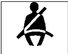
De plus, le témoin de rappel de bouclage des ceintures de sécurité s'allume et reste allumé pendant quelques secondes, puis il clignote pendant encore plus de secondes.
