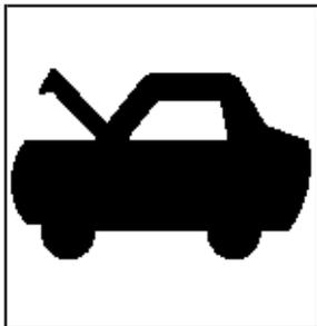
1. Tirer sur la poignée intérieure d'ouverture du capot portant ce symbole. Elle est située à gauche de la colonne de direction sous le tableau de bord.
