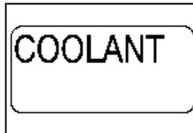
Lorsque le message COOLANT (liquide de refroidissement) s'affiche et que le moteur tourne, le niveau du liquide de refroidissement est bas.
