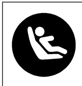
Chaque point d'ancrage arrière dispose d'une étiquette pour vous aider à repérer les ancrages inférieurs. Cette étiquette est située près de la nervure médiane du capot entre le dossier du siège et le coussin de siège, indiquant l'emplacement des ancrages.
