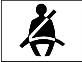
Le témoin de rappel de bouclage de ceinture de sécurité s'allume et reste allumé pendant quelques secondes, puis clignote pendant quelques secondes de plus.
