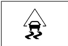
Ce témoin clignote lorsque le système de traction asservie limite le patinage des roues.
