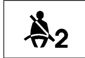
Ce carillon et ce témoin se déclenchent à nouveau si le passager ne boucle pas sa ceinture de sécurité et que le véhicule se déplace.
