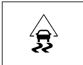
Sur les véhicules équipés d'un système de contrôle électronique de la stabilité (ESC) ou d'un système de traction asservie (TCS), ce témoin s'allume brièvement au démarrage du moteur.
