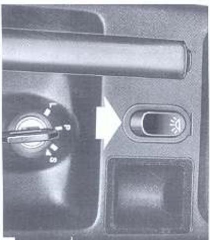
Interrupteur, éclairage intérieur
