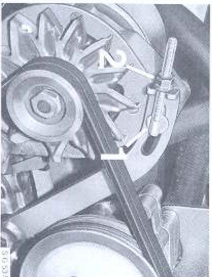
Vérification de la tension de la courroie
