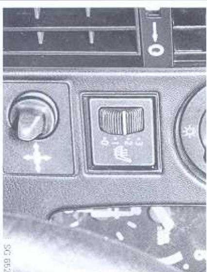
Interrupteur, siège du conducteur chauffé électriquement
