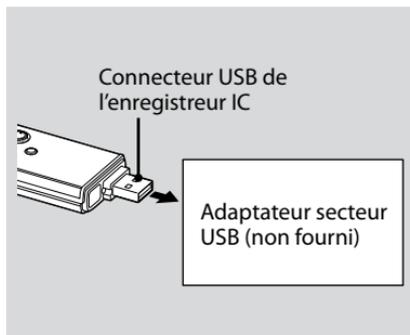
Vous pouvez recharger la pile rechargeable en raccordant l'enregistreur IC à une prise secteur à l'aide d'un adaptateur secteur USB AC-U50A/AC-U50AD (non fourni).
