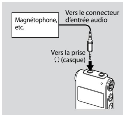
Pour enregistrer le son de l'enregistreur IC avec un autre appareil, raccordez la prise Ω (casque) de l'enregistreur IC au connecteur d'entrée audio (mini-prise, stéréo) de l'autre appareil à l'aide d'un câble de raccordement audio\*.
