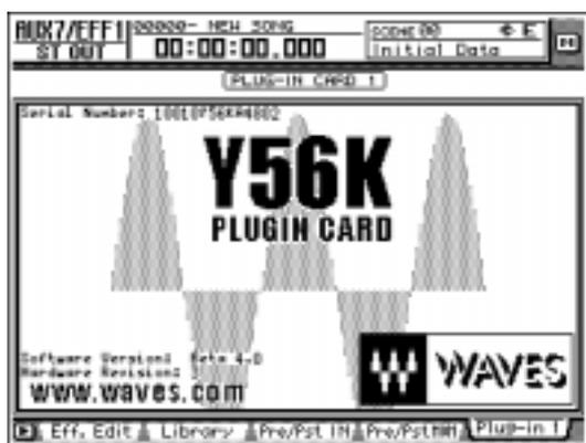
Le contenu et le maniement des pages Plug-In 1/Plug-In 2 dépend du type de carte E/S installée. L'écran illustré ici est un prototype de carte plug-in Y56K DSP produit par WAVES Corporation. Pour en savoir davantage, voyez le manuel de votre carte E/S.
