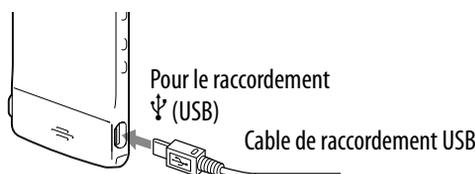
Vous pouvez recharger la batterie rechargeable intégrée en connectant l'enregistreur IC sur une sortie AC en utilisant un adaptateur USB AC (non fourni). Vous pouvez recharger la batterie lorsque vous utilisez l'enregistreur IC, ce qui fait que c'est utile lorsque vous voulez enregistrer pendant une longue période de temps.
