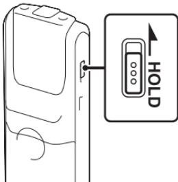
Schuif de HOLD-schakelaar in de tegengestelde richting van de pijl. De IC-recorder gaat aan en "ACCESS" knippert.
