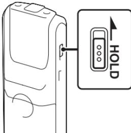
Faites glisser le commutateur HOLD dans le sens opposé à la flèche. L'enregistreur IC est mis sous tension et « ACCESS » clignote.
