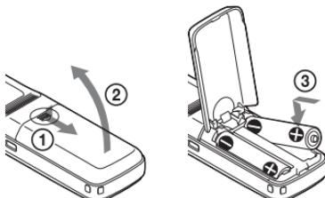
Si le couvercle du compartiment des piles se détache accidentellement, fixez-le comme illustré.
