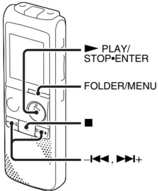
Vous devez régler l'horloge pour utiliser la fonction de réglage de l'alarme ou enregistrer la date et l'heure.
