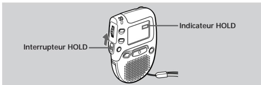
Faites coulisser l'interrupteur HOLD dans le sens de la flèche. L'indication "HOLD" s'affiche, indiquant que toutes les fonctions des touches sont verrouillées, sauf STOP pour pouvoir arrêter l'alarme.
