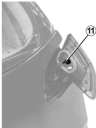
Depuis l'extérieur du véhicule, tirez sur le bloc-feux pour le déposer puis dévissez le porte-lampe **11** d'un quart de tour.
