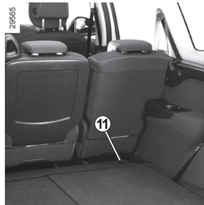
Suivant véhicule, vous devez retirer les anneaux d'arrimage **11** avant d'installer un filet de séparation des bagages.
