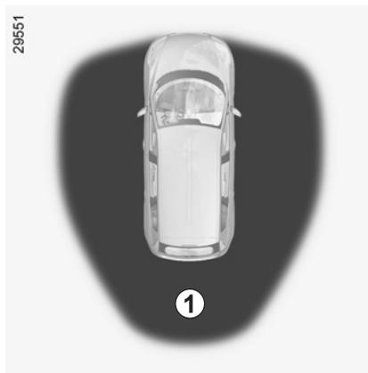
Le verrouillage est visualisé par **deux clignotements** des feux de détresse et par un bip sonore.
