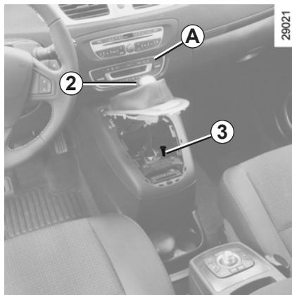
**À la mise en route**, dans le cas où le levier est bloqué sur **P** alors que vous appuyez sur la pédale de frein et sur le bouton de déverrouillage **2**, il y a possibilité de libérer manuellement le levier. Pour cela, déclipsez la base du levier de vitesses en commençant par le côté situé sous les commandes **A** de climatisation, appuyez sur le bouton **3** et appuyez simultanément sur le bouton de déverrouillage **2** situé sur le levier.
