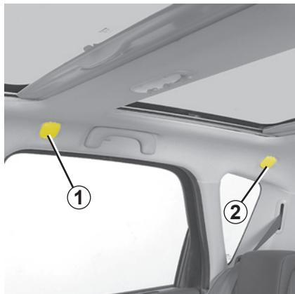
Pour les véhicules qui en sont équipés, il est utile lors du transport d'animaux ou de bagages pour les isoler de la partie passagers.
