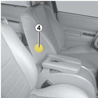
Pour régler le confort du siège conducteur au niveau des lombaires
