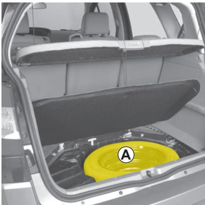
Le Bloc outils est situé dans le coffre, au centre de la roue de secours **A**.
