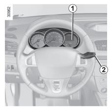
Le système connaît la pression de gonflage des pneumatiques. Les informations s'affichent suivant véhicule, au tableau de bord. Dans ce cas, elles apparaissent :
