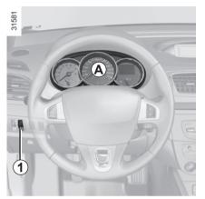
**Tableau de bord** *A* : Il s'éclaire à la mise sous contact. Vous pouvez en régler l'intensité lumineuse en tournant la molette *1*.
