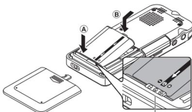
Insérez la pile de manière à ce qu'elle soit placée sous la partie saillante de l'enregistreur (voir illustration).
