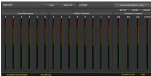
*Panneau de configuration du pilote de la Fast Track C600, disposition Horizontal (Meters Only)*
