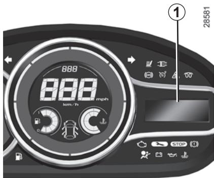
Lorsque le véhicule en est équipé, cette fonction, intégrée à l'ordinateur de bord **1**, permet l'activation/désactivation et le réglage de certaines fonctions du véhicule.
