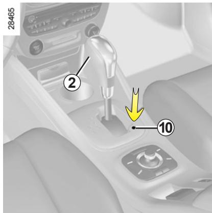
**À la mise en route**, dans le cas où le levier est bloqué sur **P** alors que vous appuyez sur la pédale de frein et sur le bouton de déverrouillage **2**, il y a possibilité de libérer manuellement le levier. Pour cela, appuyez sur le bouton en passant un objet dans le trou **10** et appuyez simultanément sur le bouton de déverrouillage **2** situé sur le levier.
