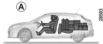
Placez toujours les objets transportés de façon à ce que leur plus grande dimension soit en appui contre le dossier de la banquette arrière, ce qui est le cas pour les chargements usuels (Exemple **A**) ou contre les dossiers des sièges avant lorsque les dossiers de la banquette arrière sont rabattus.
