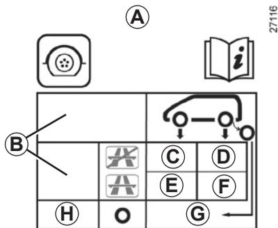
**F** : pression de gonflage des pneumatiques pour les roues arrière lors de roulage sur autoroute.
