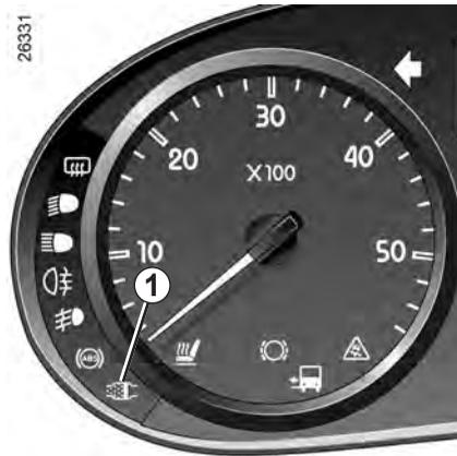
Le témoin de filtre à particules **1** s'allume pour indiquer un risque de saturation du filtre.
