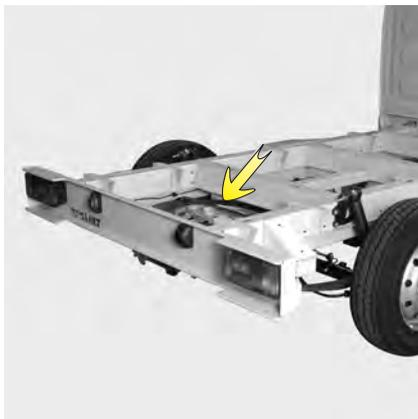
Dans le cas d'une crevaison à l'arrière avec un véhicule châssis chargé, il est impératif auparavant de lever le véhicule (par le point de levage le plus près de la roue concernée) pour pouvoir accéder à la roue de secours.
