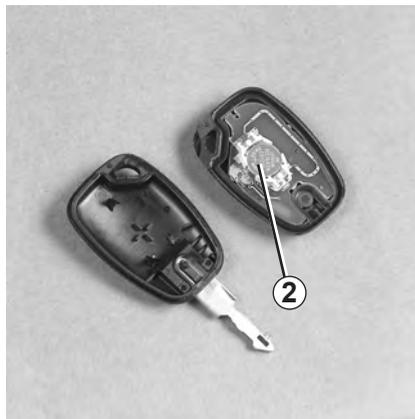
Remplacez la pile **2** en respectant la polarité gravée sur le couvercle.
