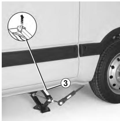
Débloquez légèrement les vis de la roue en plaçant la clé à cliquets 2 de façon à appuyer dessus, et non à tirer vers le haut.
