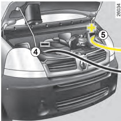
Pour brancher le compresseur, ouvrez le capot moteur et branchez la pince noire 7 sur l'élément de masse 4 (reportez-vous en chapitre 5 « Batterie dépannage »).
