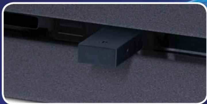
Insérez l'adaptateur sans fil dans le port USB.
