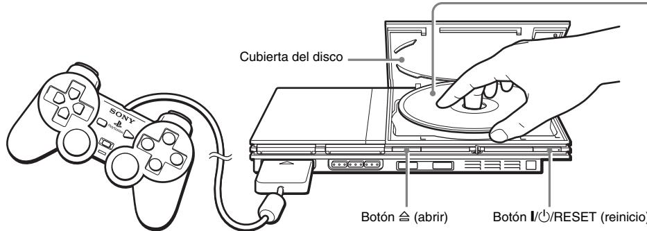
Inserte el disco en la consola con la cara de la etiqueta hacia arriba.
