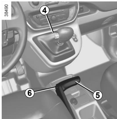
**A la mise en route**, dans le cas où le levier est bloqué sur **P** alors que vous appuyez sur la pédale de frein, il y a possibilité de libérer manuellement le levier. Pour cela, déclipsez le cache à l'embase du levier et appuyez simultanément sur le repère **4** et sur le bouton de déverrouillage **6** situé sur le levier.
