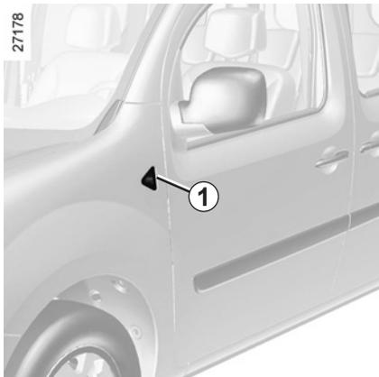
Déclippez le répéteur **1** du côté de la porte, à l'aide d'un outil type tournevis plat.
