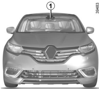
L'alerte de survitesse avec reconnaissance des panneaux de signalisation informe le conducteur du dépassement de la limitation de vitesse sur la portion de route sur laquelle il se trouve.
