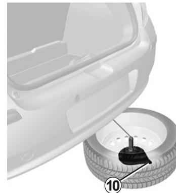
Placez-vous derrière le véhicule et tirez sur la poignée **6** pour soulever la roue jusqu'à son accrochage sous le véhicule.
