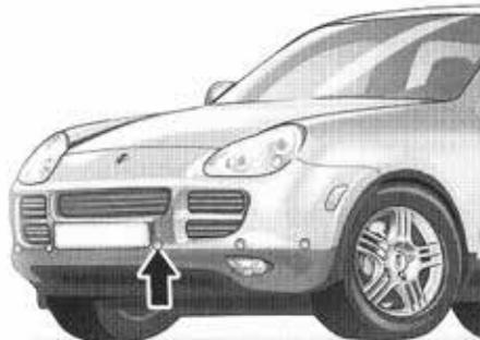
Capteurs à ultrasons avant
