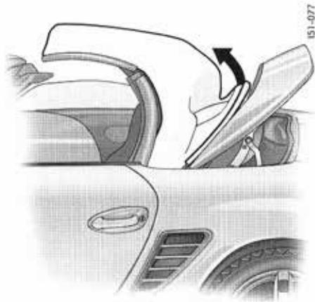
5. Rabattez la partie arrière de la capote vers l'avant. Appuyez en même temps sur la partie supérieure de la lunette arrière.
