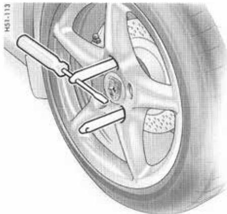
Vissez les **2** auxiliaires de montage sur les véhicules **avec** freins PCCB
