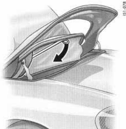
6. Décrochez la fermeture Velcro de la sangle de maintien.
