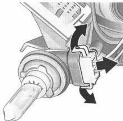
2. Écartez les deux languettes de verrouillage du connecteur.
