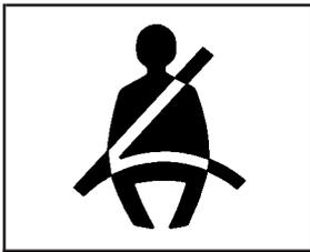
De plus, le témoin de rappel de bouclage des ceintures de sécurité s'allume et reste allumé pendant quelques secondes, puis il clignote pendant quelques secondes.
