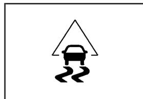
Ce témoin clignote lorsque le système de traction asservie limite le patinage des roues.
