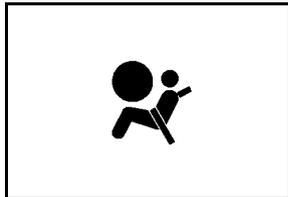
Ce témoin s'allume le véhicule démarre, puis clignote pendant quelques secondes. Son extinction signale que le système fonctionne correctement.
