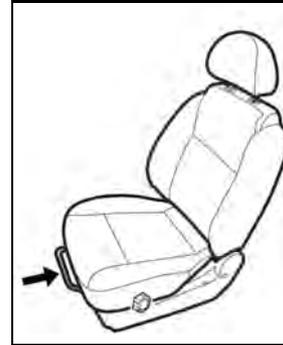
1. Lever la barre placée sous l'avant du siège pour déverrouiller le siège.
