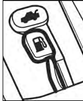
Le levier de déverrouillage se trouve sur l'extérieur du siège du conducteur. Tirer le levier pour ouvrir le coffre.
