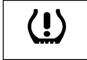
Sur les véhicules dotés d'un système de surveillance de la pression des pneus, ce témoin s'allume brièvement lorsque le moteur démarre.
