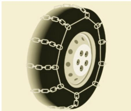
**i** Les chaînes à neige doivent être montées sur les roues motrices. Elles ne doivent pas être montées sur les roues de secours de type "galette".
