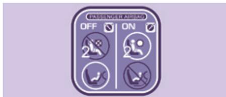
**+** L'airbag frontal passager doit être impérativement neutralisé, si un siège enfant est installé dos à la route.
