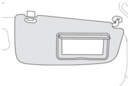
Les pare-soleil se déplient vers l'avant, et sur le côté lorsqu'ils sont décrochés. Ils sont équipés d'un miroir de courtoisie et d'un range-ticket.
