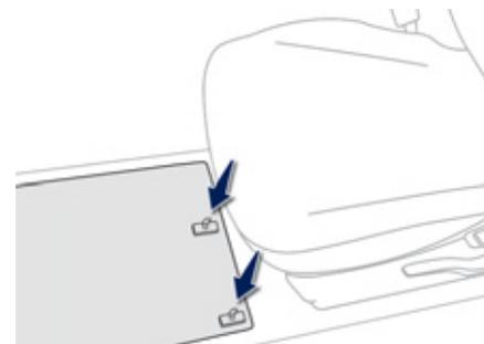
Lors du démontage du surtapis côté conducteur, reculez le siège au maximum et retirez les fixations. Au remontage, positionnez-le correctement sur les pions et clippez les fixations. Vérifiez la bonne tenue du surtapis.
