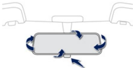
Ajustez le rétroviseur en le déplaçant vers le haut, le bas, et/ou vers la gauche, la droite.
