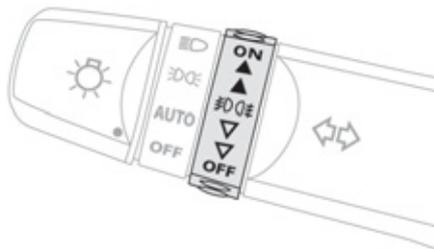
Bague de sélection des feux antibrouillard. Ils fonctionnent avec les feux de position, de croisement et de route.
