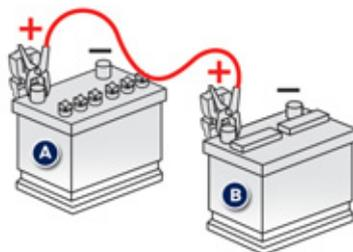
**!** Vérifiez bien que la batterie de secours est une batterie 12 V.
