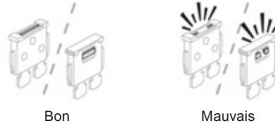
Avant de remplacer un fusible, il est nécessaire de connaître la cause de la panne et d'y remédier.
