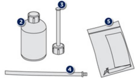
2. Flaçon de produit de colmatage pour réparer temporairement la roue.
