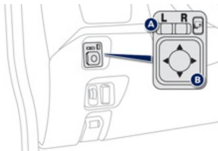
Le réglage est possible lorsque le contacteur est sur la position «ON» ou «ACC».
