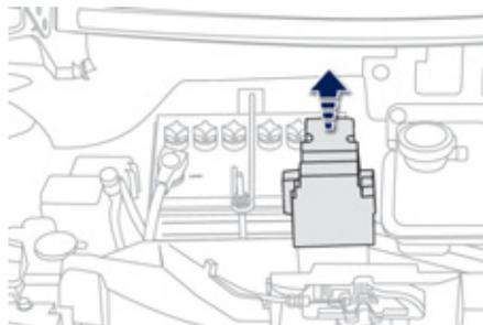
**!** Assurez-vous que l'électrolyte ne soit pas gelé. Vérifiez le niveau et faites le complément avec de l'eau distillée, si nécessaire (reportez-vous à la partie «vérifications des niveaux» de ce document).
