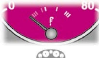
A la mise du contact, l'aiguille indique le niveau d'huile du moteur, puis retourne à zéro.
