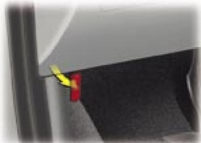
**A l'intérieur** : tirez la commande située côté gauche, sous le tableau de bord.
