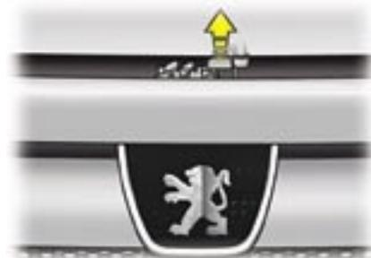
**A l'extérieur** : levez la commande, soulevez le capot et fixez la béquille pour maintenir le capot ouvert.
