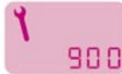
5 secondes après la mise du contact, le totalisateur kilométrique reprend son fonctionnement normal et la clé reste allumée.
