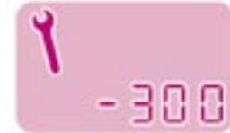
5 secondes après la mise du contact, le totalisateur kilométrique reprend son fonctionnement normal et la clé de maintenance reste allumée. L'afficheur indique le kilométrage total ou journalier.
