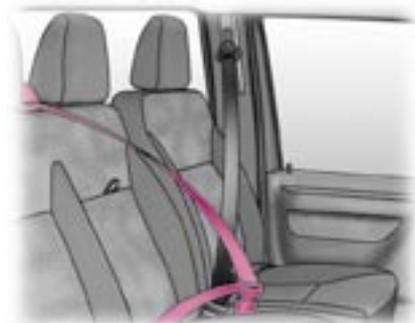
La place avant centrale de la banquette passager deux places est équipée d'une ceinture intégrée, dotée de trois points d'ancrage et d'un enrouleur.
