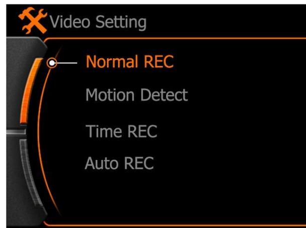
a. Normal REC : Ceci signifie que la camera commencera l'enregistrement suite à un appui sur le bouton déclencheur, pour stopper l'enregistrement il vous suffira d'appuyer une nouvelle fois sur ce bouton. La vidéo sera sauvegardée.
