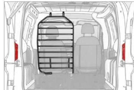
Une séparation verticale de type échelle protège le conducteur des risques de déplacement de charge.
