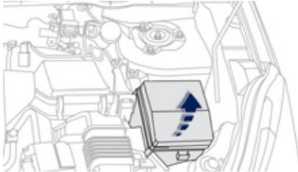
La boîte à fusibles est placée dans le compartiment moteur (côté gauche).
