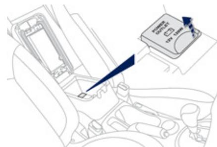
Elle fonctionne lorsque le contacteur est en position «LOCK», «ACC» ou «ON». Ouvrez le couvercle de l'accoudoir avant pour accéder à la prise.
