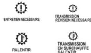
Contact mis, l'allumage du message **«Ralentir»** ou du message **«Entretien nécessaire»** sur l'afficheur du combiné indiquent un dysfonctionnement de la boîte de vitesses.
