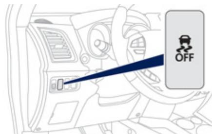
Appuyez sur ce bouton, situé à gauche du volant, jusqu'à l'apparition du symbole dans l'écran du combiné.
