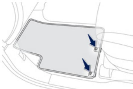
Lors du démontage du surtapis côté conducteur, reculez le siège au maximum et retirez les fixations.
