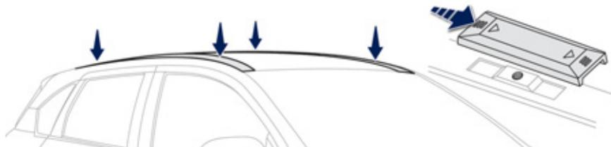
Les barres transversales se fixent directement sur le toit du véhicule, sur 4 points d'ancrage masqués par des caches.
