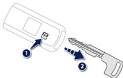
La clé intégrée sert à verrouiller ou déverrouiller le véhicule lorsque la clé électronique ne peut pas fonctionner :
