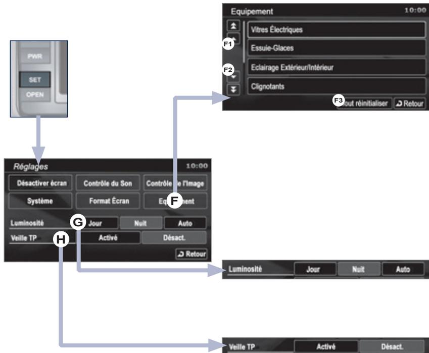
**F** - Choisir de régler ou paramétrer certains équipements proposés dans votre véhicule (ex. : déploiement/rabattement des rétroviseurs, remontée des vitres au verrouillage, temporisation et sensibilité de l'éclairage automatique, fonction autoroute des clignotants, ...) :
