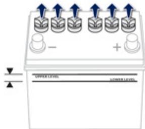
Si nécessaire, compléter avec de l'eau distillée en retirant les bouchons des différents compartiments de la batterie. Vérifiez le niveau de l'électrolyte au moins une fois par mois.
