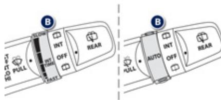
B. bague de réglage de l'intermittence ou de la sensibilité du capteur de pluie.
