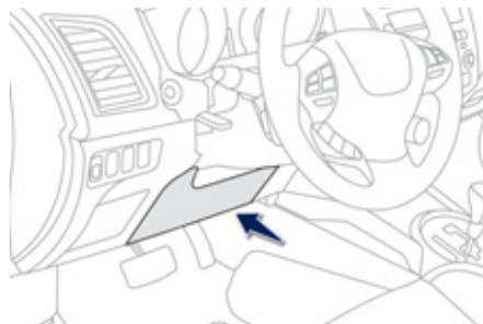
Système protégeant, en cas de choc frontal violent, les genoux du conducteur. Cet airbag est intégré dans la planche de bord sous la colonne de direction.
