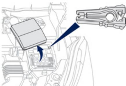
La pince d'extraction et les fusibles de rechange sont installés dans la boîte à fusibles du compartiment moteur.
