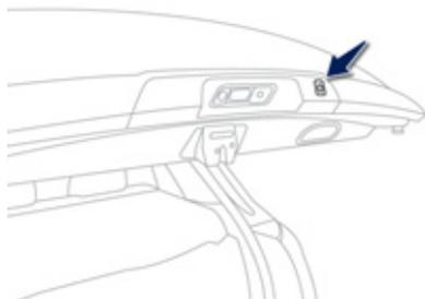
Liée à l'option navigation, la caméra de recul complète le système d'aide au stationnement et s'active automatiquement au passage de la marche arrière.
