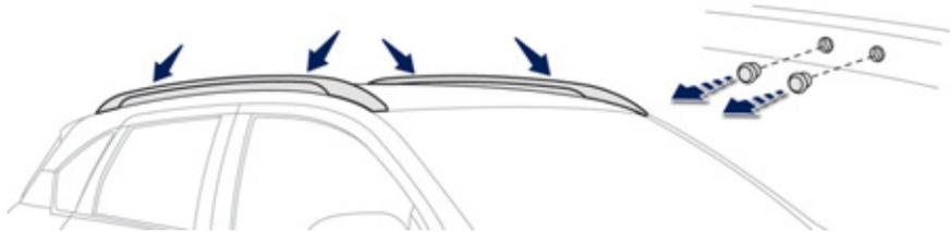
Les barres de toit transversales se fixent sur les barres de toit longitudinales à l'aide de 8 points d'ancrage masqués par des caches.
