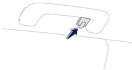
La poignée arrière gauche est équipée d'un crochet porte-manteaux.
