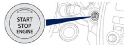
Chaque appui sur le bouton **START/STOP**, sans action sur les pédales, permet le changement de mode du véhicule.
