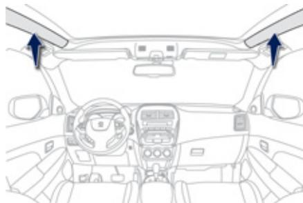
Lorsqu'il est activé, l'éclairage du toit panoramique s'allume si le contacteur est placé en position «ON» ou «ACC».
