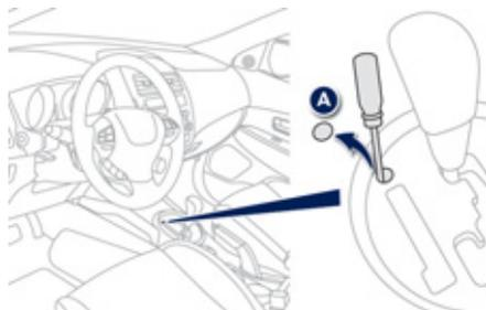
Si la batterie est déchargée ou si le mécanisme de blocage du sélecteur de vitesse est endommagé, il est possible que le sélecteur soit bloqué en position **P**, même lorsque vous appuyez franchement sur la pédale de frein.
