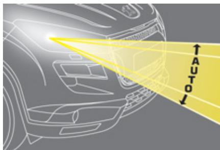
Sur les véhicules équipés de lampes au xénon : **à l'arrêt**, le système corrige automatiquement la hauteur du faisceau, quel que soit l'état de charge du véhicule. Le conducteur est alors assuré d'avoir un éclairage optimal et de ne procurer aucune gêne aux autres usagers de la route.
