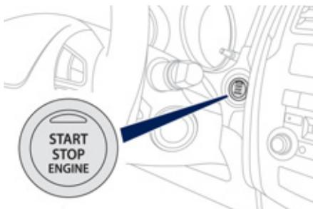
Avec la clé électronique à l'intérieur du véhicule ; chaque appui sur le bouton «**START/STOP**», **sans action sur les pédales**, permet le changement de mode du véhicule :
