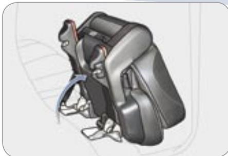
Le passager a accès à la troisième rangée de sièges en basculant un siège de la deuxième rangée.
