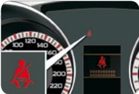
Dans la minute après avoir mis le contact, si le conducteur ne boucle pas sa ceinture, le témoin clignote accompagné d'un signal sonore intermittent et d'un affichage dans l'écran du combiné.
