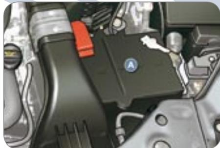
La batterie **A** est située sous le capot moteur à gauche.
