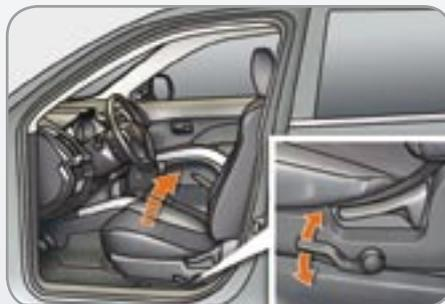
Hauteur et inclinaison de l'assise du siège conducteur
