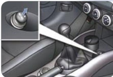
Lorsque le contacteur est placé en position «ON» ou «ACC», appuyez sur l'allume-cigare.
