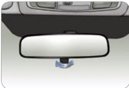
Ajustez le rétroviseur en le déplaçant vers le haut, le bas, et/ou vers la gauche, la droite.
