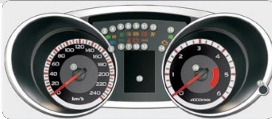
Panneau regroupant les cadrans et les témoins. Ceux-ci informant le conducteur de la mise en marche d'un système (témoins de marche ou de neutralisation) ou de l'apparition d'un défaut (témoin d'alerte).
