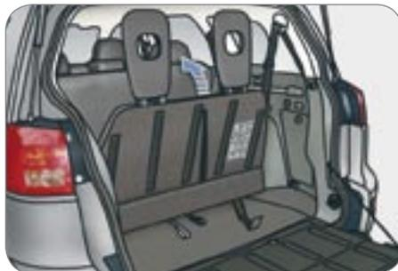
7. Soulevez et poussez l'ensemble de la banquette vers l'avant, jusqu'au verrouillage.
