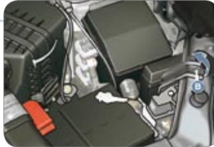
Lorsque vous remplacez une ampoule du côté gauche, retirez l'écrou **B** de la fixation de la boîte à relais et déplacez-la vers l'arrière.
