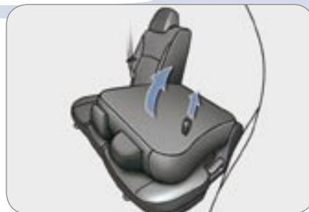
3. Redressez le dossier du siège en tirant simultanément sur la courroie de déverrouillage située à l'arrière du dossier du siège.
