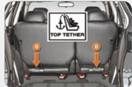
Un anneau **B** permet la fixation de la sangle haute appelée **TOP TETHER**.
