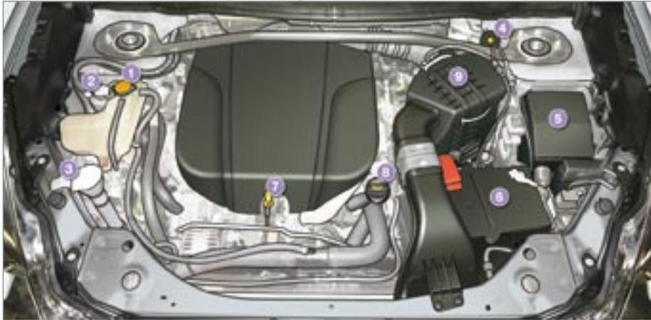
1. Réservoir du liquide de refroidissement.
