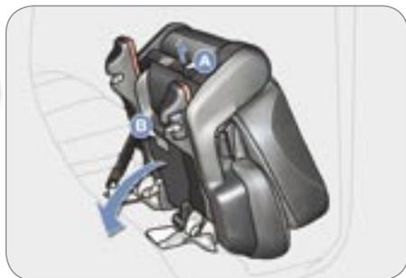
1. Abaissez le siège en tirant simultanément sur la courroie de déverrouillage **A** située à l'arrière de l'assise et en soutenant le siège de la main.
