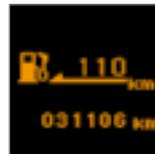
**Moteur tournant**, il indique le nombre de kilomètres pouvant être encore parcourus avec le carburant restant dans le réservoir en fonction de la consommation moyenne des derniers kilomètres parcourus.
