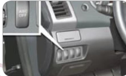
Appuyez sur le bouton «ASC OFF», situé à gauche du volant, jusqu'à l'apparition du symbole ASC OFF dans l'écran du combiné.
