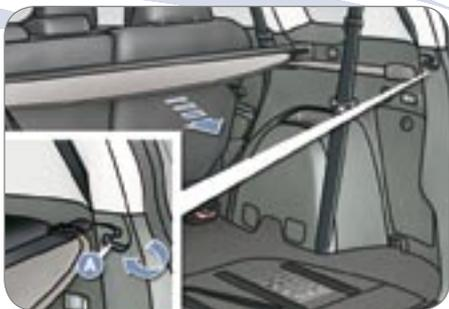
Déroulez le cache-bagages et installez-le dans la rainure de fixation **A**.
