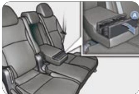
Ouvrez le couvercle **A** situé à l'extrémité de l'accoudoir, en retenant le côté avec la main.
