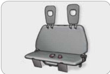
La banquette arrière est rabattable. Elle s'escamote dans un logement situé dans le plancher du véhicule.
