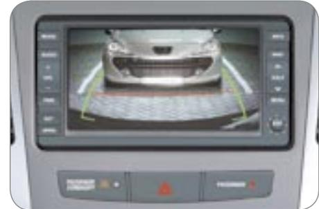
Liée à l'option navigation, une caméra de recul s'active automatiquement au passage de la marche arrière.
