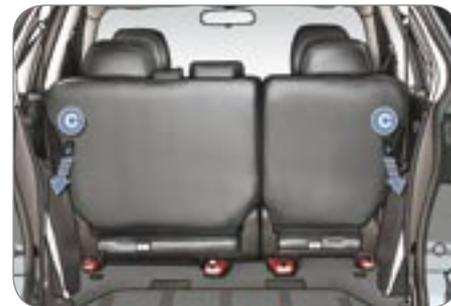
1. Soulevez la manette de siège arrière **A**, ou Tirez sur le bouton du coffre à bagages **B**, pendant au moins une seconde, ou Tirez la courroie de déverrouillage du siège arrière **C** vers vous.
