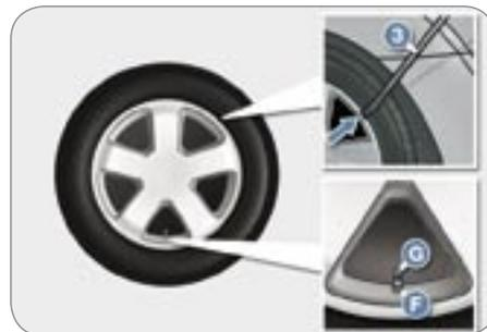
**Lors du démontage de la roue**, dégagez au préalable l'enjoliveur à l'aide de la manivelle **3** en tirant au niveau de l'encoche.
