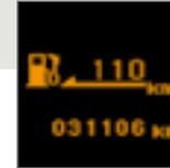
Moteur tournant, il indique le nombre de kilomètres pouvant être encore parcourus avec le carburant restant dans le réservoir en fonction de la consommation moyenne des derniers kilomètres parcourus (voir chapitre «L'autonomie»).
