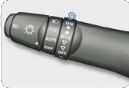
**C.** bague de sélection des feux antibrouillard.
