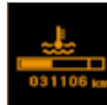
Moteur tournant, il indique la température du liquide de refroidissement (voir chapitre «L'indicateur de température du liquide de refroidissement»).
