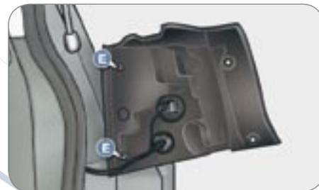
Lors du remontage du feu, alignez les deux broches **E** avec les orifices situés sur le véhicule.
