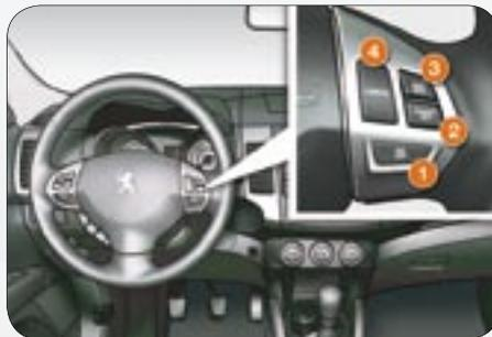
Il permet de maintenir, de façon constante, la vitesse du véhicule programmée par le conducteur.
