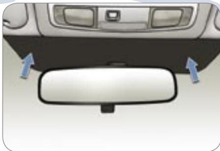
Le pare-brise athermique comporte une zone non réfléchissante située au-dessus de la base du rétroviseur intérieur.
