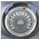
☞ Tournez la molette de contrôle de température vers la droite pour augmenter la température, et vers la gauche pour la diminuer.
