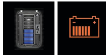
**i** Pour préserver la durée de vie de la batterie, le niveau de charge ne descend jamais en dessous d'un seuil de 20% de charge, même si le niveau est affiché à 0 barrette après un roulage ZEV.
