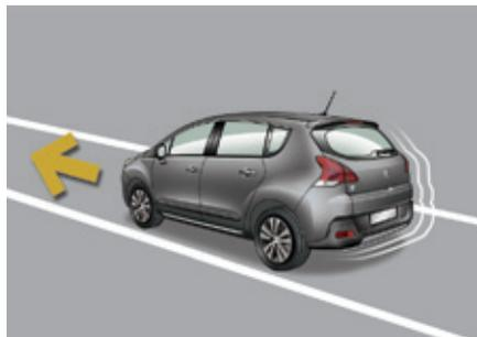
**En pente montante, véhicule à l'arrêt, le véhicule est maintenu un court instant dès que vous relâchez la pédale de frein, si le sélecteur de vitesses est en position A ou M.**
