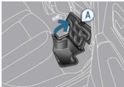
Selon les configurations, le véhicule est équipé d'espaces de rangement sous pieds, situés devant les sièges arrière latéraux. Ils sont accessibles par des trappes clipées, dotées d'une poignée de préhension **A**.
