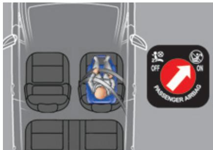
Lorsqu'un siège enfant «face à la route» est installé en **place passager avant**, réglez le siège du véhicule en position longitudinale arrière maximum, position la plus haute, dossier redressé. Laissez l'airbag passager actif.
