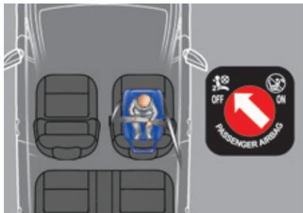
Lorsqu'un siège enfant «dos à la route» est installé en **place passager avant**, réglez le siège du véhicule en position longitudinale arrière maximum, position la plus haute, dossier redressé.
