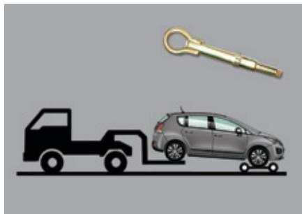
Les roues avant ou arrière ne doivent pas être sur le sol, utilisez un plateau pour remorquer votre véhicule.
