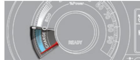
Utilisez la zone «**charge**» : anticipez les ralentissements en levant le pied de l'accélérateur plutôt qu'en freinant. La déviation de l'aiguille sur l'indicateur de consommation / génération d'énergie (dans la zone «charge»), indique le niveau de récupération d'énergie.
