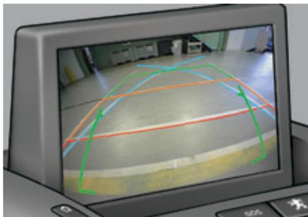
Une caméra de recul s'active automatiquement au passage de la marche arrière. Le retour visuel couleur de l'arrière du véhicule se fait sur l'écran de navigation.
