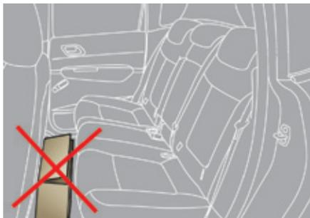
La batterie haute tension est équipée d'un système de refroidissement par air, composé d'une aspiration (située sous le siège arrière gauche) et d'un ventilateur (situé derrière la garniture de coffre gauche).
