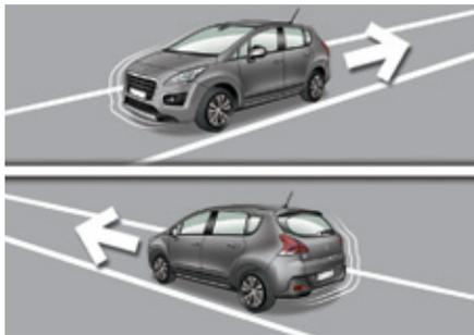
Votre véhicule est équipé d'un système qui le maintient immobilisé un court instant (environ 2 secondes) pour aider au démarrage en pente, le temps que vous passiez de la pédale de frein à la pédale d'accélérateur.
