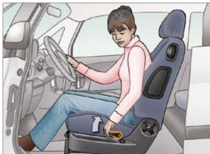
2. Réglage en hauteur du siège conducteur.
