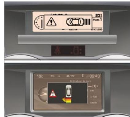
Lorsque la distance «arrière véhicule/obstacle» est inférieure à trente centimètres, le signal sonore devient continu et le symbole «Danger» apparaît sur l'écran multifonction.
