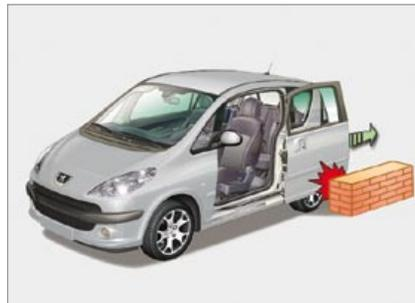
Une porte, en position ouverte, dépasse de 8 mm la largeur du rétroviseur extérieur, veillez à en tenir compte quand vous vous gardez le long d'un mur, d'un poteau ou d'un trottoir élevé ...
