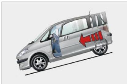
Toutefois, si votre véhicule est situé dans une pente, l'avant du véhicule dirigé vers le bas, la porte peut ne pas rester ouverte et se refermer brutalement au risque d'entraîner des blessures.
