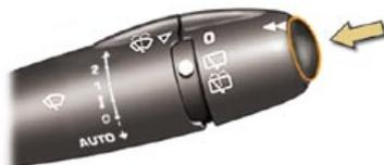
☞ Appuyez sur le bouton, situé à l'extrémité de la **commande d'essuie-vitre**, pour afficher successivement les différentes données de l'ordinateur de bord.
