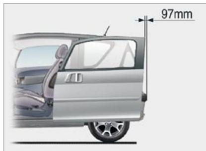
Une porte, en position ouverte, ne dépasse jamais le pare-choc arrière du véhicule.
