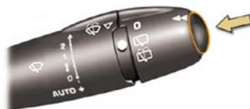
Appuyez sur le bouton, situé à l'extrémité de la **commande d'essuie-vitre**, pour afficher successivement les différents onglets de l'ordinateur de bord :
