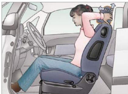
4. Réglage en hauteur et inclinaison de l'appuie-tête.
