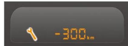
10 secondes après la mise du contact, le totalisateur kilométrique reprend son fonctionnement normal et la clé reste allumée.
