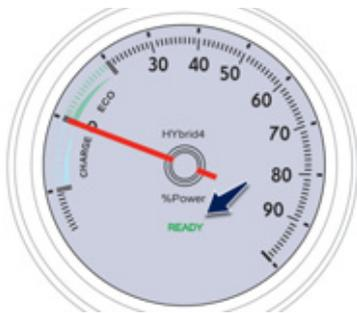
A l'activation du système HYbrid4, ce témoin s'allume pour vous signaler que le véhicule est prêt à rouler.
