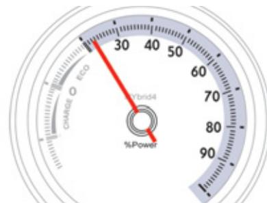
Indique une augmentation de la **sollicitation de puissance** cumulée de votre véhicule, tenant compte des capacités combinées du moteur Diesel HDi et du moteur électrique.
