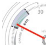
Indique que le véhicule **optimise sa consommation de carburant** en électrique, en Diesel ou en combinant les deux.
