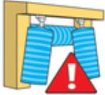
Certaines stations ou tunnels (véhicule transporté au moyen d'un tapis de convoyage) imposent que le frein de stationnement soit desserré pendant le lavage.
