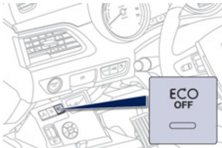
Cette fonction empêche la coupure du moteur Diesel et privilégie ainsi le confort thermique dans l'habitacle (maintien de la climatisation en permanence).
