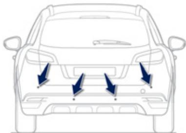
A l'aide de capteurs situés dans le pare-chocs, cette fonction vous signale la proximité de tout obstacle (personne, véhicule, arbre, barrière...) qui entre dans leur champ de détection. Certains types d'obstacle (piquet, balise de chantier...) détectés au début ne le seront plus en fin de manoeuvre en raison de la présence de zones aveugles.
