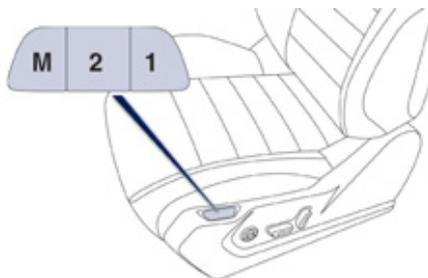
Système prenant en compte les réglages électriques du siège conducteur et des rétroviseurs extérieurs ainsi que les réglages de l'affichage tête haute. Il vous permet de mémoriser jusqu'à deux positions à l'aide des touches sur le côté du siège conducteur.
