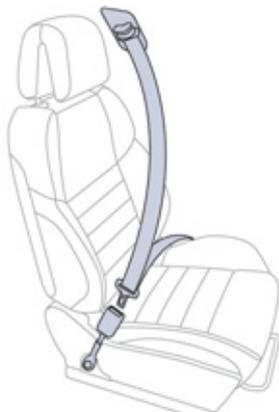
Les ceintures de sécurité avant sont équipées d'un système de prétension pyrotechnique et de limiteur d'effort.
