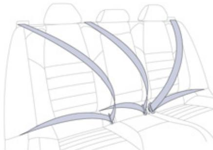
Les places arrière sont équipées chacune d'une ceinture, dotée de trois points d'ancrage et d'un enrouleur avec limiteur d'effort (sauf pour le passager arrière central).
