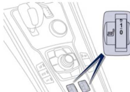
Système hybride actif, les sièges avant peuvent être chauffés séparément.
