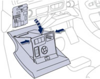
La boîte à fusibles est placée dans la partie inférieure de la planche de bord (côté gauche).
