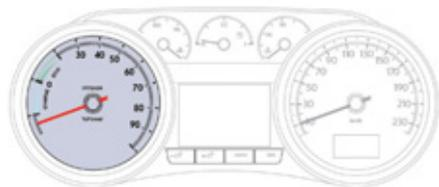
Le cadran permet de visualiser en temps réel la puissance totale utilisée, en cumulant l'électrique et le Diesel.
