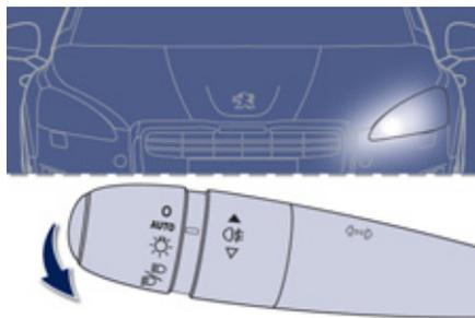
Balisage latéral réalisé par l'allumage des feux de position uniquement du côté de la circulation.
