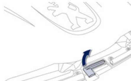
☞ **À l'extérieur** : levez la commande et soulevez le capot. Un vérin ouvre et maintient le capot ouvert.
