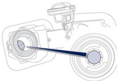
Lors de son introduction dans votre réservoir Diesel, le pistolet essence vient buter sur le volet. Le système reste verrouillé et empêche le remplissage.
