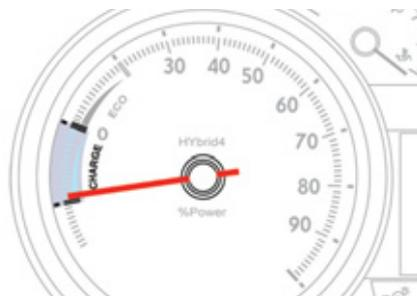
Zone qui indique que le véhicule est en phase de **récupération d'énergie** électrique : en décélération, freinage ou pied levé, ...
