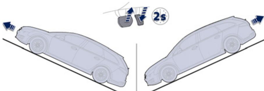
**En pente montante, véhicule à l'arrêt, le véhicule est maintenu un court instant dès que vous relâchez la pédale de frein, si le sélecteur de vitesses est en position A ou M.**
