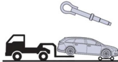
Les roues avant ou arrière ne doivent pas être sur le sol, utilisez un plateau pour remorquer votre véhicule.
