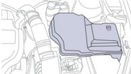
La boîte à fusibles est placée dans le compartiment moteur près de la batterie.
