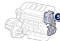
La **boîte de vitesses mécanique pilotée - 6** permet en mode automatique des gains significatifs de consommation par rapport à une boîte de vitesses classique, grâce à sa gestion électronique. Elle offre également un agrément de conduite procuré par la possibilité de choisir à tout moment le mode de passage des vitesses : automatique ou manuel à l'aide des palettes, situées derrière le volant.
