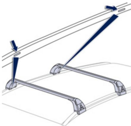
Pour installer des barres de toit transversales, respectez leur positionnement. Il est matérialisé par des repères sur chacune des barres longitudinales.
