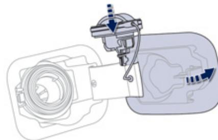
2. Ouverture et accrochage du bouchon de réservoir.
