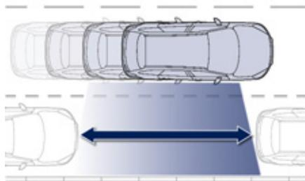
Le système ne mesure pas les emplacements dont la taille est nettement inférieure ou supérieure au gabarit du véhicule.
