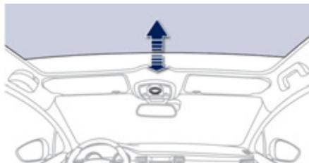
Celui-ci est commandé électriquement par une commande rotative d'ouverture.
