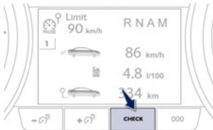
Un appui sur le bouton «**CHECK**» du combiné lance le CHECK manuel (autotest du véhicule). Cette fonction permet de connaître, à tout moment (clé en position contact ou moteur tournant), les alertes présentes.
