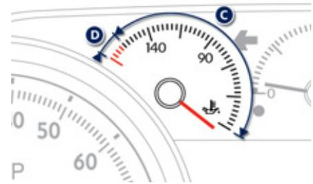
A la mise du contact ou véhicule roulant, il indique la température d'huile moteur.
