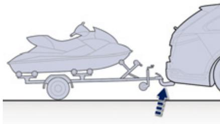
Dispositif mécanique adapté à l'accrochage d'une remorque ou l'installation d'un porte-vélos, avec une signalisation et un éclairage complémentaires.
