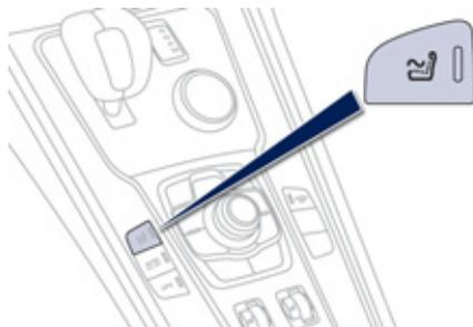
Cette fonction assure un massage lombaire au conducteur et ne fonctionne que moteur tournant ainsi qu'en mode STOP du Stop & Start.
