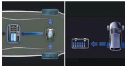
La batterie se charge lorsque le véhicule décélère, le moteur électrique devient alors générateur et transforme l'énergie cinétique en énergie électrique (sauf si le véhicule est à plus de 120 km/h).
