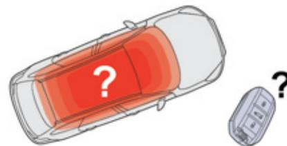
Si la clé électronique n'est plus dans la zone définie lorsque vous roulez ou demandez l'arrêt du système hybride (ultérieurement), un message apparaît au combiné.
