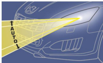
Pour ne pas gêner les autres usagers de la route, ce système corrige, automatiquement et à l'arrêt, la hauteur du faisceau des lampes au xénon, en fonction de la charge du véhicule.
