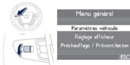
**A l'arrêt**, utilisez la molette gauche du volant pour naviguer dans les menus afin de configurer les paramètres du véhicule (équipements de conduite et de confort, ...).
