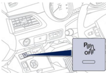
La neutralisation de la fonction s'effectue par un appui sur ce bouton. Le voyant du bouton s'allume.
