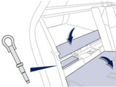
L'anneau de remorquage est installé derrière les sièges arrière.
