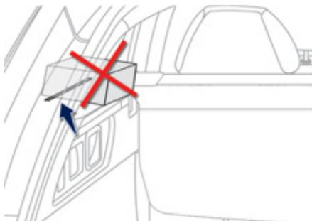
La batterie haute tension est équipée d'un système de refroidissement par air, composé d'une aspiration (située sur la plage arrière) et d'un ventilateur (situé sous la garniture de coffre).
